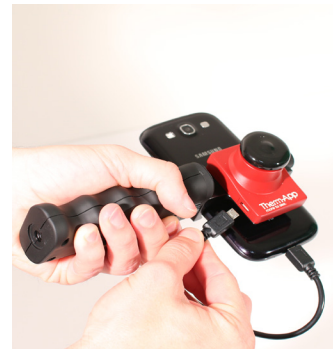
Connexion de la Therm-App TH au SmartPhone via le câble USB
