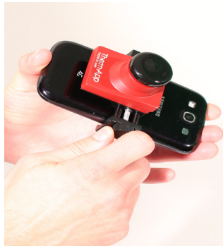
Fixation de la Therm-App TH sur le SmartPhone à l'aide de la molette
