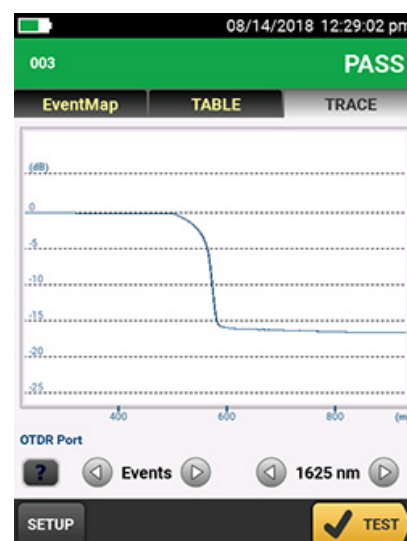
Séparateur tel que vu sur une trace OTDR
