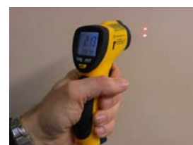
Distance de mesure < distance focale
