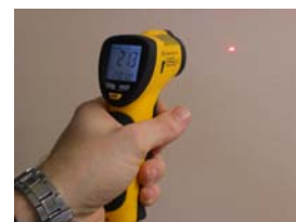
Distance de mesure = distance focale
