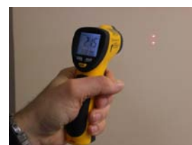
Distance de mesure > distance focale
