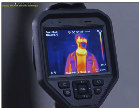
Image thermique avec échelle de température
