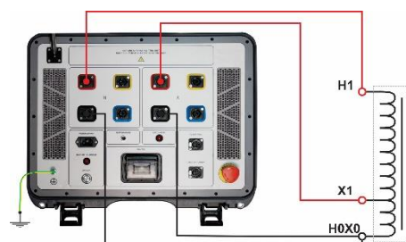
Connexion du TWR-B à un autotransformateur monophasé
