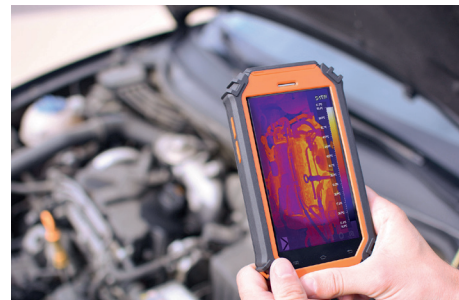
Contrôle des points chauds sur un moteur
