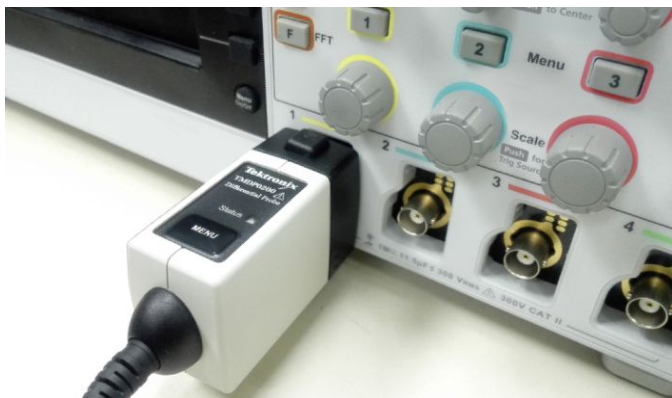
Les sondes TekVPI communiquent les réglages d'échelle, les plages et l'état du TBS2000.
