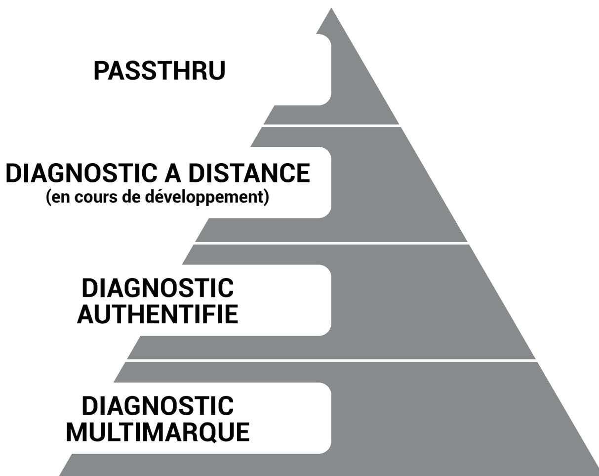
Le diagnostic peut être représenté comme une pyramide à plusieurs niveaux, dont la base est le diagnostic multimarque et le sommet est le PassThru. Différents parcours de diagnostic peuvent également être suivis pendant la réparation.
