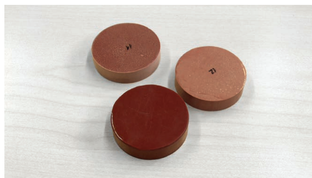
Modifications de couleur dans des échantillons en résine moulée résultant de produits de décomposition dans le gaz SF 6
