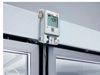
Surveillance du congélateur très basse température au laboratoire (testo Saveris 2-T3 avec sonde de température)
