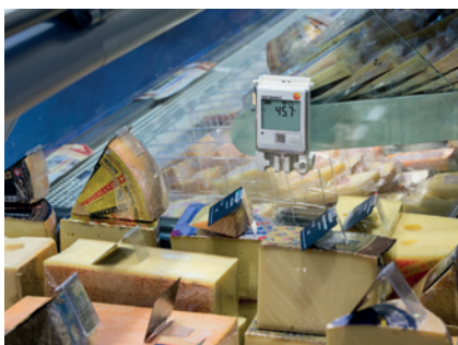
Surveillance des congélateurs au supermarché (testo Saveris 2-T1)
