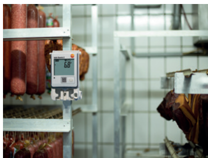
Surveillance de la chambre froide chez le boucher (testo Saveris 2-T2 avec sonde CTN externe avec contact de porte)
