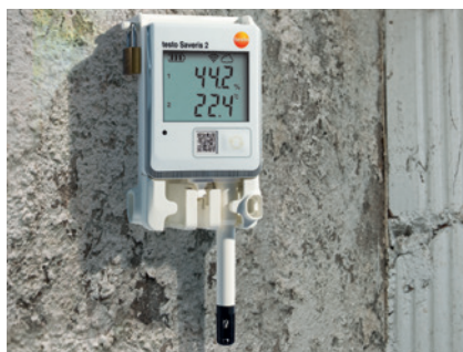
Prévention de moisissures - humidité de chantier (testo Saveris 2-H2 avec sonde d'humidité numérique externe 0572 2154)
