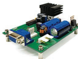
Régulateur pile à combustible
