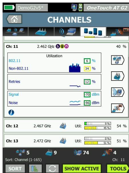
Figure 14. Visibilité sur chaque canal Wi-Fi, indiquant la bande passante occupée par le trafic 802.11 et non 802.11
