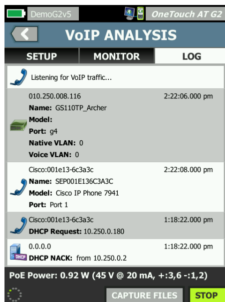
Figure 18. L'analyse VoIP décrit le processus complet de configuration des appels ainsi que la qualité de l'appel dans chaque direction
