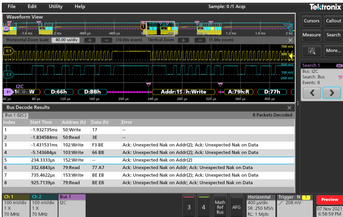
Un signal de bus fournit des paquets décodés corrélés dans le temps, tandis que le tableau de décodage bus présente tous les paquets de l'intégralité de l'acquisition, la navigation par recherche est possible
