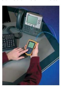
IntelliTone pour localiser avec précision pratiquement tous les câbles ou paires, quel que soit l'environnement de travail. Utilisez le mode numérique pour localiser un câblage réseau de haute qualité (Cat. 5e/6/6a) regroupé en faisceaux, ou au niveau des commutateurs, panneaux de brassage ou prises murales. Vous pouvez également utiliser le mode analogique sur un câblage de qualité téléphonique (Cat. 3 et inférieur) mais aussi coaxial, sécurité/alarme et hautparleurs.
