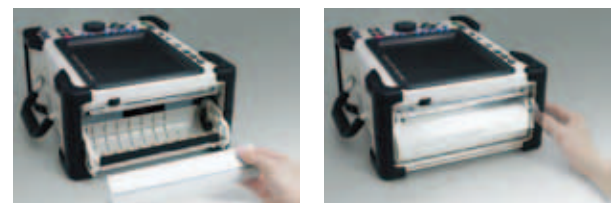
Ouvrez simplement le capot, insérez le nouveau papier, puis fermez le capot.
