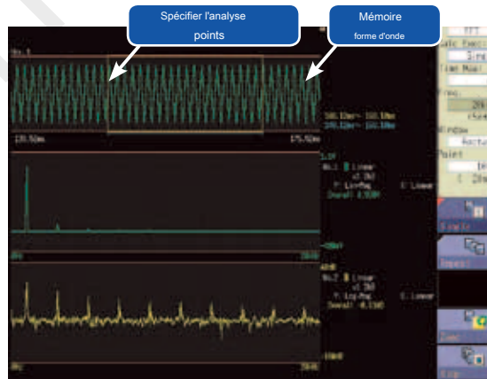
Afficher la source de calcul (forme d'onde mémoire) et les résultats du calcul FFT en même temps
