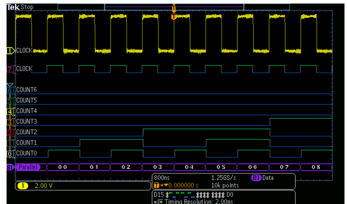
La Série MDO3000 avec l'option MDO3MSO propose 16 voies numériques intégrées qui permettent d'afficher et d'analyser des signaux analogiques et numériques corrélés dans le temps.
