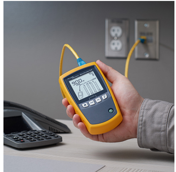
Figure 5. Le MicroScanner PoE peut détecter la puissance offerte par l'équipement PSE et la vitesse du réseau, il vient également présenter une suite de fonctionnalités de test des câbles.
