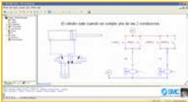
autoSIM-200 est un software qui permet de créer et de simuler des circuits pneumatiques, électropneumatiques, hydrauliques, etc. Tout comme la programmation de ceux-ci et la monitorisation et commande des modèles 2D et 3D prédéfinis.
