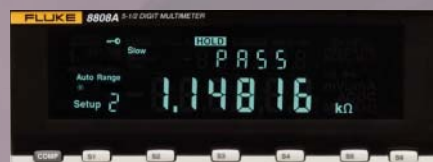
Le mode de comparaison des limites et ses indicateurs bon/mauvais peuvent éviter les erreurs de fabrication.
