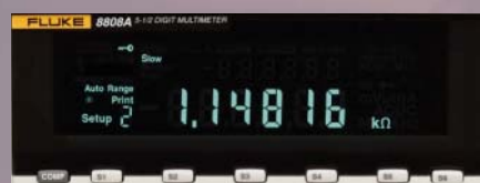
Paramétrez six mesures usuelles sous les boutons en façade et exécutez-les simplement en appuyant sur le bouton approprié.
