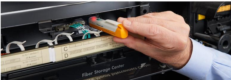
Déterminer si un port est actif. La petite taille facilite l'accès aux panneaux de brassage crampons.
