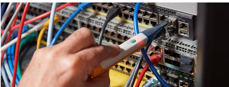
Déterminer si un émetteur-récepteur est opérationnel. FiberLert peut détecter les signaux fibre optique sans établir de contact.
