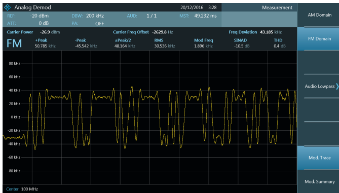
R&S®FPC-K7 : analyse de modulation FM.
