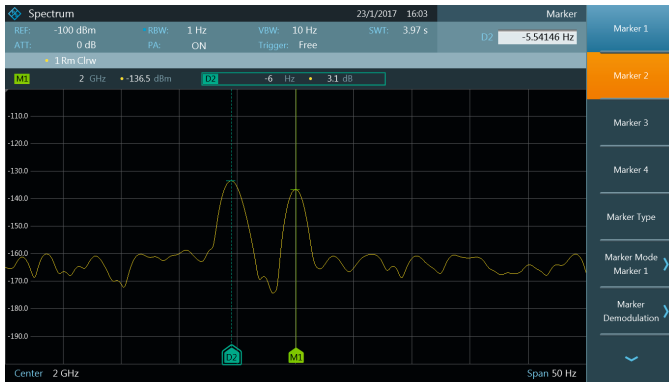
R&S®FPC-B22 : sensibilité élevée avec préamplificateur interne.
