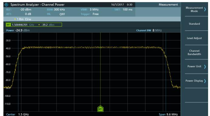
R&S®FPC-K55 : mesure de la puissance de canal.
