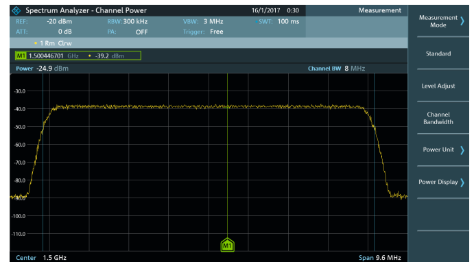
R&S®FPC-K55 : mesure de la puissance de canal.
