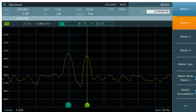
R&S®FPC-B22 : sensibilité élevée avec préamplificateur interne.
