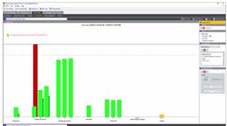
Fluke Energy Analyze Plus : résumé de l'état de la qualité du réseau électrique
