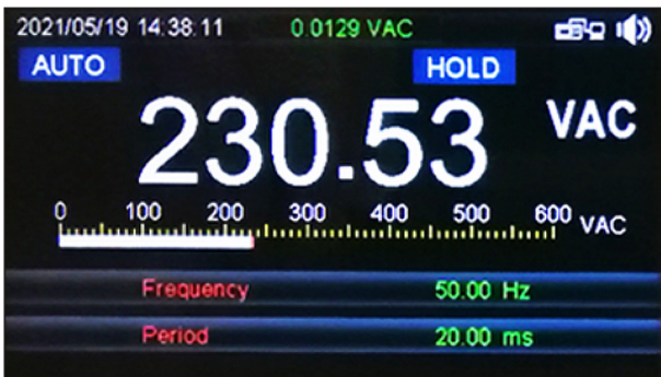
Triple affichage tension / fréquence / période Bargraphe analogique 60 segments
