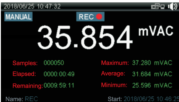
Enregistrement des données en cours [REC] Jusqu'à 20 000 mesures en mémoire
