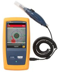
Comme la saleté peut être un problème avant, pendant ou après les tests de certification des fibres optiques et qu'elle peut migrer d'une extrémité à l'autre lors du couplage, les deux extrémités de toute connexion doivent toujours être nettoyées et inspectées.
