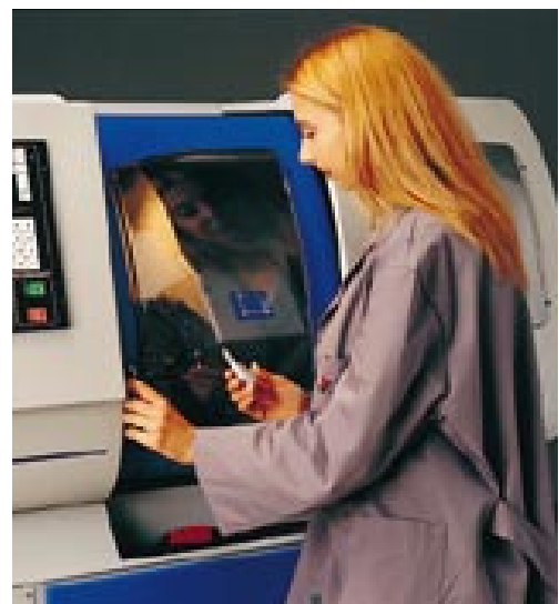
Protecteur mobile avec dispositif de verrouillage
