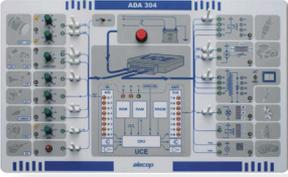
Cet équipement est conçu pour étudier le fonctionnement d'une unité de commande électronique (UCE) de moteur à essence, avec injection multipoint séquentiel et allumage statique. Grâce à des potentiomètres, il simule différentes conditions (température d'air, réfrigérant, etc.) que l'UCE utilise pour contrôler les actionneurs (injecteurs, bobines, ventilateur). Un mode automatique empêche les anomalies en ajustant les capteurs selon un algorithme programmé.
