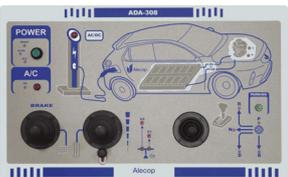
Le pupitre ADA-308 permet l'étude conceptuelle des véhicules électriques (VE). Il simule leur fonctionnement sur différents trajets, réalise des essais, affiche les paramètres clés (tension batterie, rendement), et visualise les flux d'énergie. Il analyse aussi l'interaction entre moteur et générateur, et enregistre les valeurs réelles comme la vitesse et le couple.
