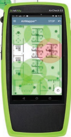
Etude de site avec l'application AirMapper sur le AirCheck G3
