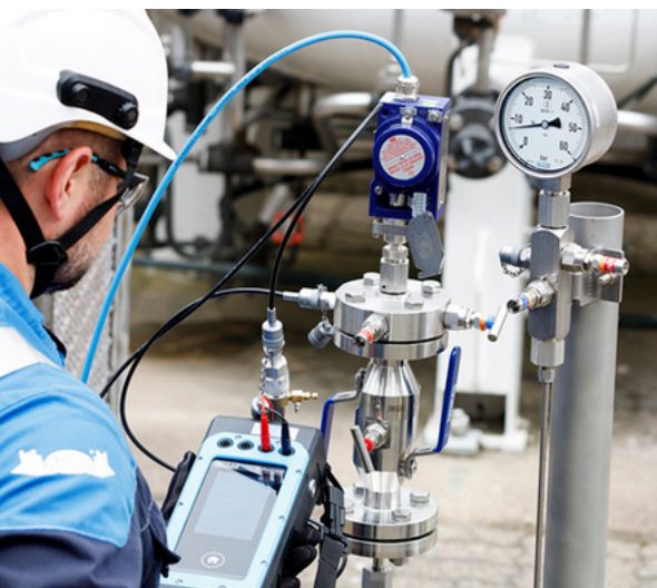
▲ Calibrateur de pression portable CPH7000
