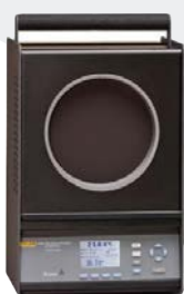
▶ Calibrateur avec corps noir pour thermomètre infrarouge
