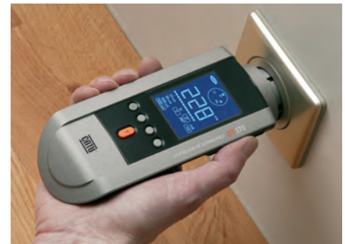
Fig.1 : affichage d'une valeur correcte en temps de déclenchement (exemple : 228ms)
