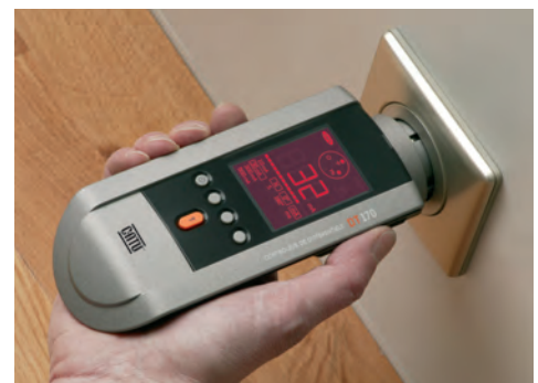
Fig.2 : affichage d'une valeur incorrecte en valeur de courant (exemple : 32mA pour un DDR de 30mA)
