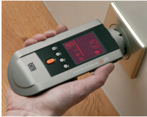
Exemple d'affichage en cas d'absence de terre et phase à droite.
