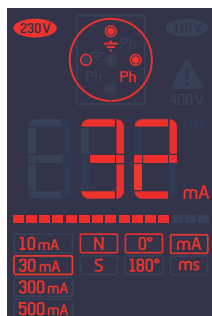
Exemple d'affichage d'une valeur incorrecte > à 30mA
