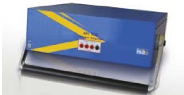
L'amplificateur triphasé de courant AMI 332 est un équipement additionnel pour le DRTS 64. Cette option nécessite le module d'extension de sorties et de synchronisation IRIG-B implanté sur le DRTS 64 et inclut 3 générateurs de courant jusqu'à 32 A chacun. Connecté à un DRTS 64, les spécifications techniques sont les suivantes :
