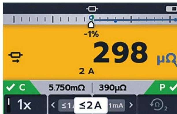
Une nouvelle mesure est effectuée et est inférieure de seulement 1 % à la première. L'aiguille se déplace jusqu'à la position -1 % sur l'échelle
