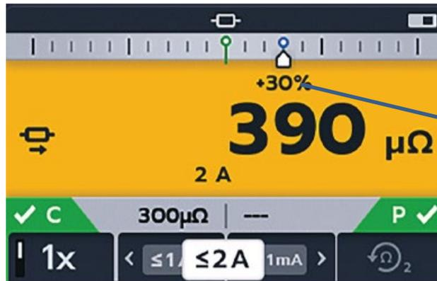
La nouvelle mesure est supérieure de 30 % à la première. L'aiguille se déplace jusqu'à la position 30 % sur l'échelle.
