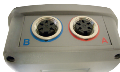
2 ports de connexion pour entrées de sonde de température
