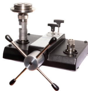
Balance manométrique version compacte, type CPB3800
