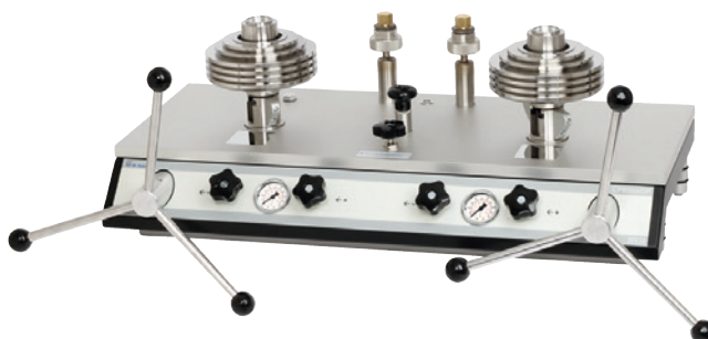
Balance manométrique pour pression différentielle, type CPB5600DP
