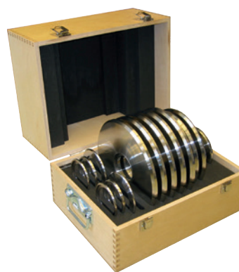
Jeu de masses type CPM5800 (exemple d'image)
