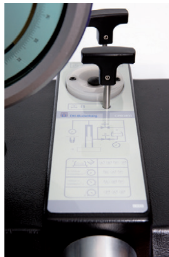
Schéma opérationnel de la base de l'instrument de la balance CPB3800
