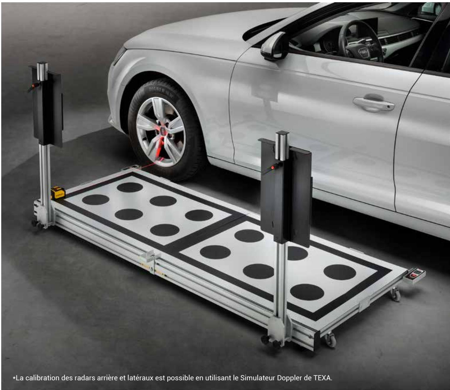
\*La calibration des radars arrière et latéraux est possible en utilisant le Simulateur Doppler de TEXA.
