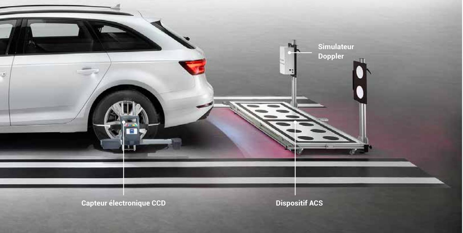
Capteur électronique CCD
