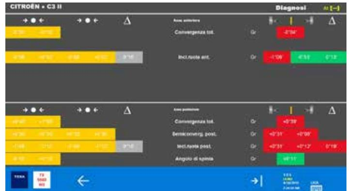
Ecran récapitulatif des données relevées par les quatre capteurs CCD, par rapport aux valeurs nominales établies par le constructeur. Si ces valeurs entrent dans les tolérances, il est possible de procéder au positionnement du RCCS 3 BT.
