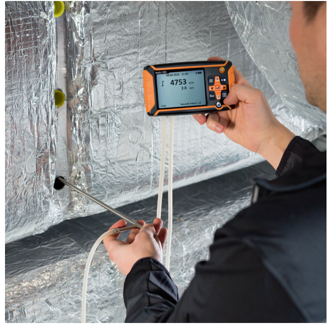
Appareil amovible permettant des mesures dans les canalisations au moyen d'un tube de Pitot (tube de Pitot disponible séparément)
